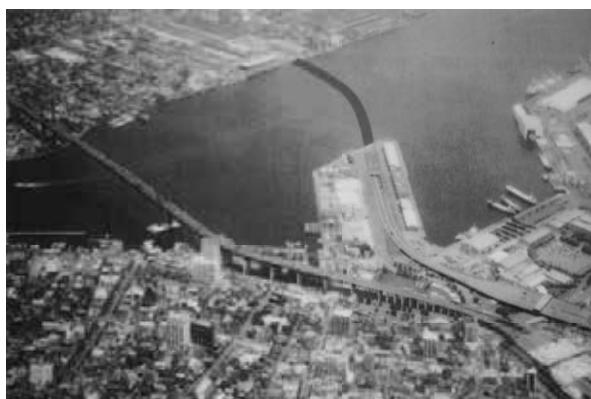
若戸大橋に並行して沈埋トンネルが建設された（右側の線）
