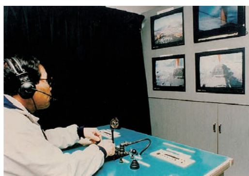
無人の重機—ダンプトラック、ブルドーザーなどを遠隔操作する
