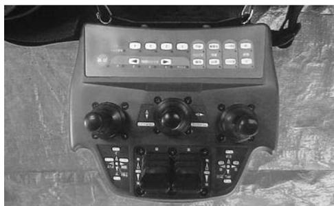
「ロボQ」の操縦盤。人間の判断を重機に伝える
