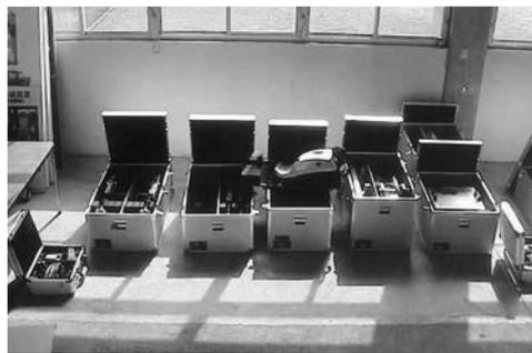
「ロボQ」は分解され、ケースで災害現場に運搬される
