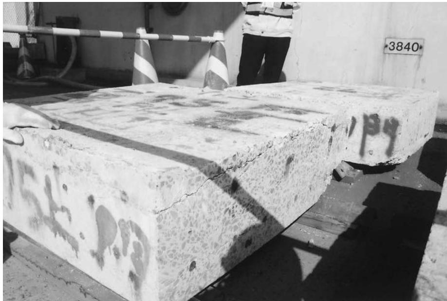
膨大な交通量による過酷な負担に耐えた関門国道トンネルの車道版。大きなヒビ割れが見られる。
